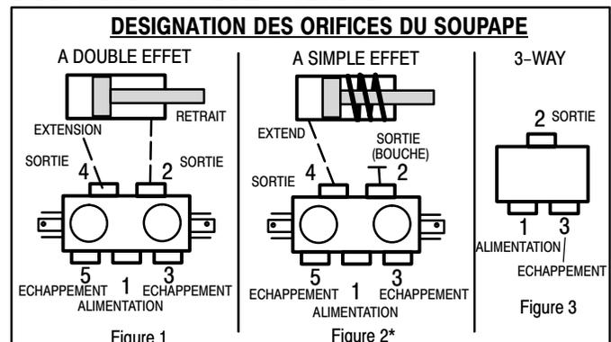
\* Le schéma ci-dessus présente une valve de fonction "normalement fermée" En obturant l'orifice No 4 à la place de l'orifice No 2, cette même valve prend une fonction "normalement ouverte".
