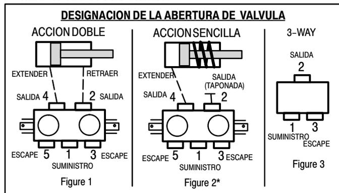
\* La válvula indicada esta "normalmente cerrada". Moviendo el tapón de la entrada #2 hacia la entrada #4 cambiaría la función de la válvula a "normalmente abierta".
